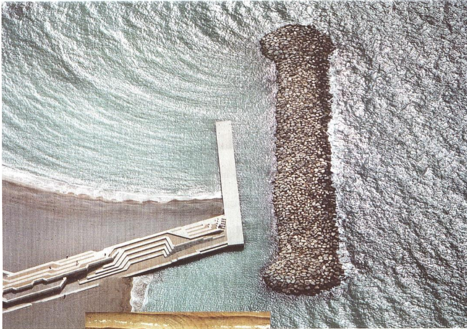
Pour bien évaluer le mouvement de l'eau, le tracé des plages a été expérimenté sur une maquette avec simulateur de houle
