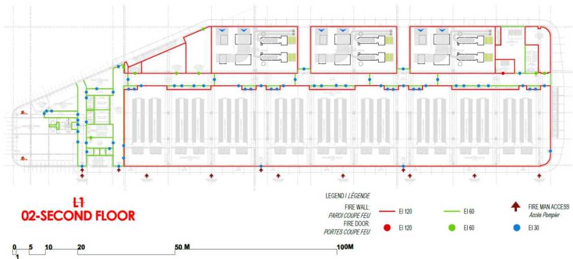
Figure 21 : Emplacement des murs coupe-feu au R+1
