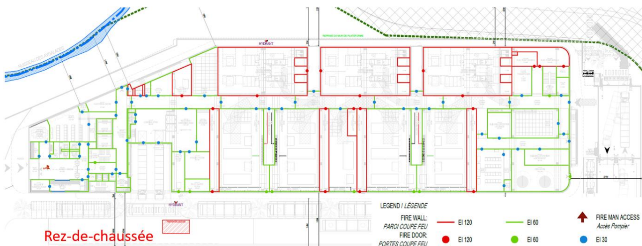
Figure 20 : Emplacement des murs coupe-feu au RDC
