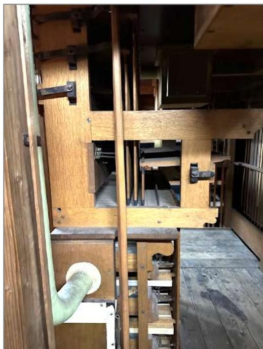
*Figure 49 : Mécanismes de la machine Barker*
