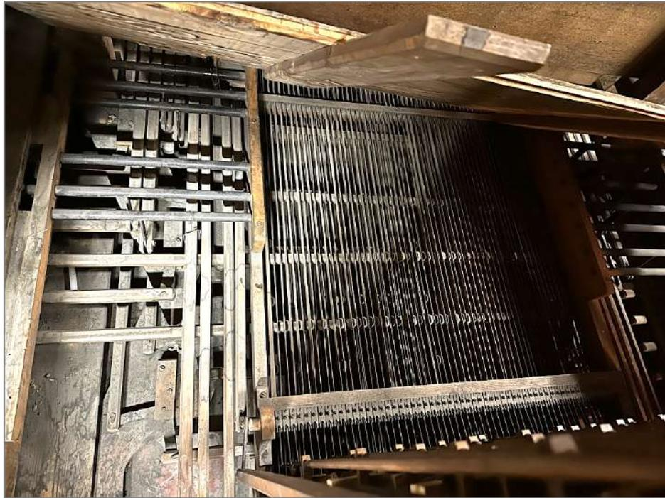
Figure 50: Distribution des mécanique venues depuis la console, dans le soubassement, vue de dessus, en face de la machine Barker
