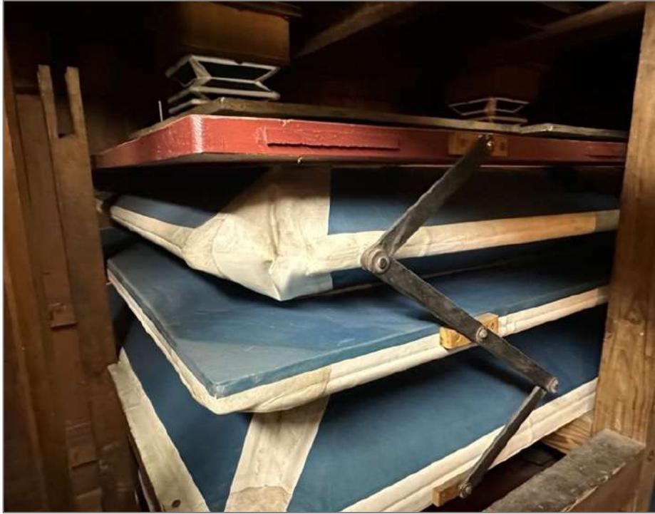
*Figure 24 : Réservoir primaire n°2 du Positif*
