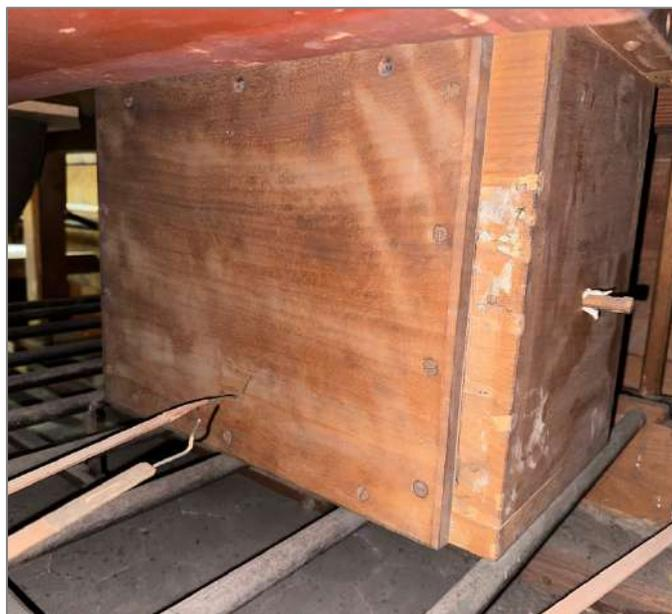
Figure 27 : Soupape de régulation (sous REC)
