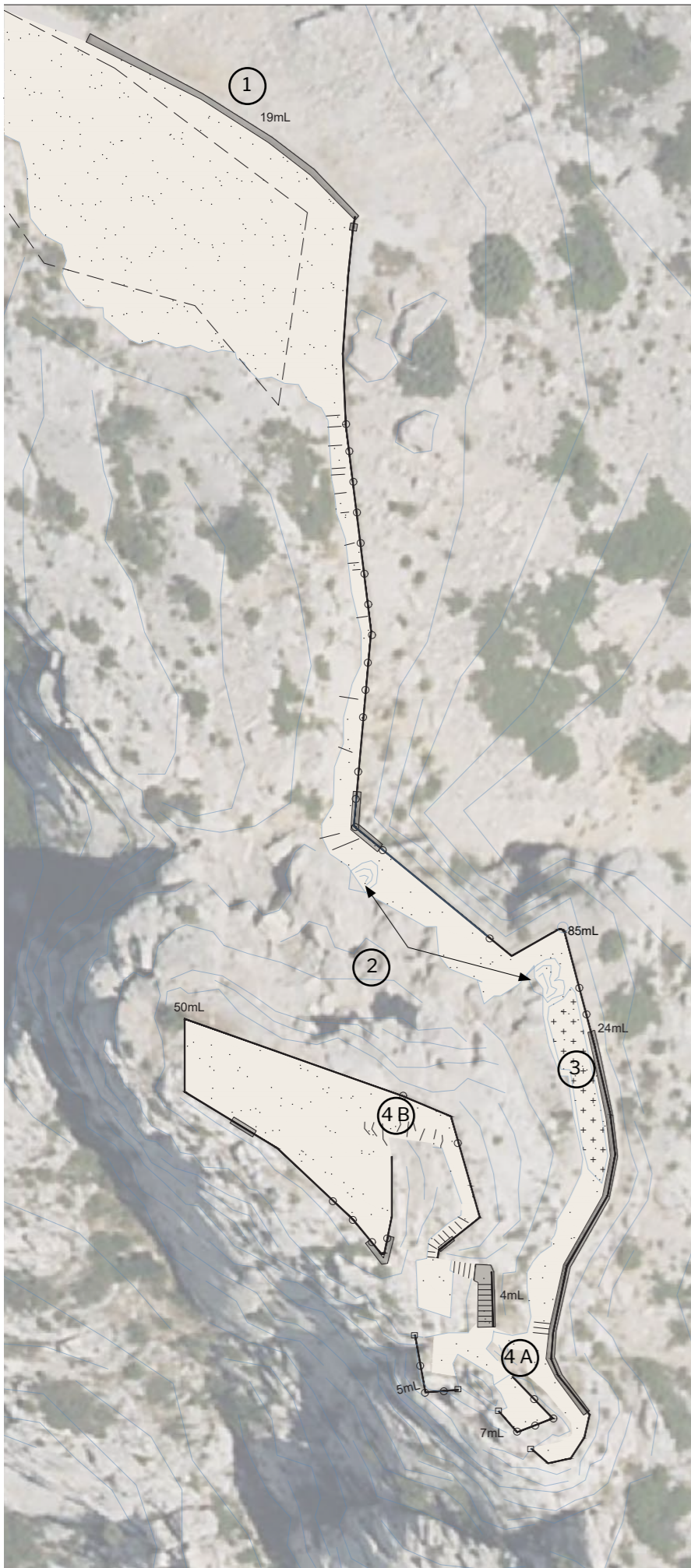
① DÉMOLITION ET RECONSTRUCTION DU MURET ASSISE DE LA PLATEFORME D'APPROCHE
