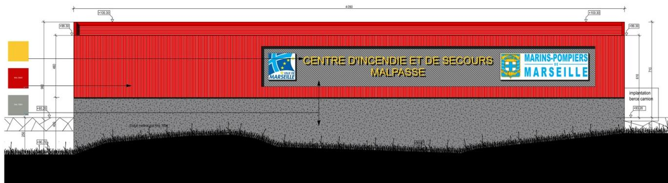
Dans la proposition architecturale, il est prévu environ **30 m<sup>2</sup> de panneaux sandwich posé en façon horizontale en surpasseur de la peau extérieure coté voirie.**
