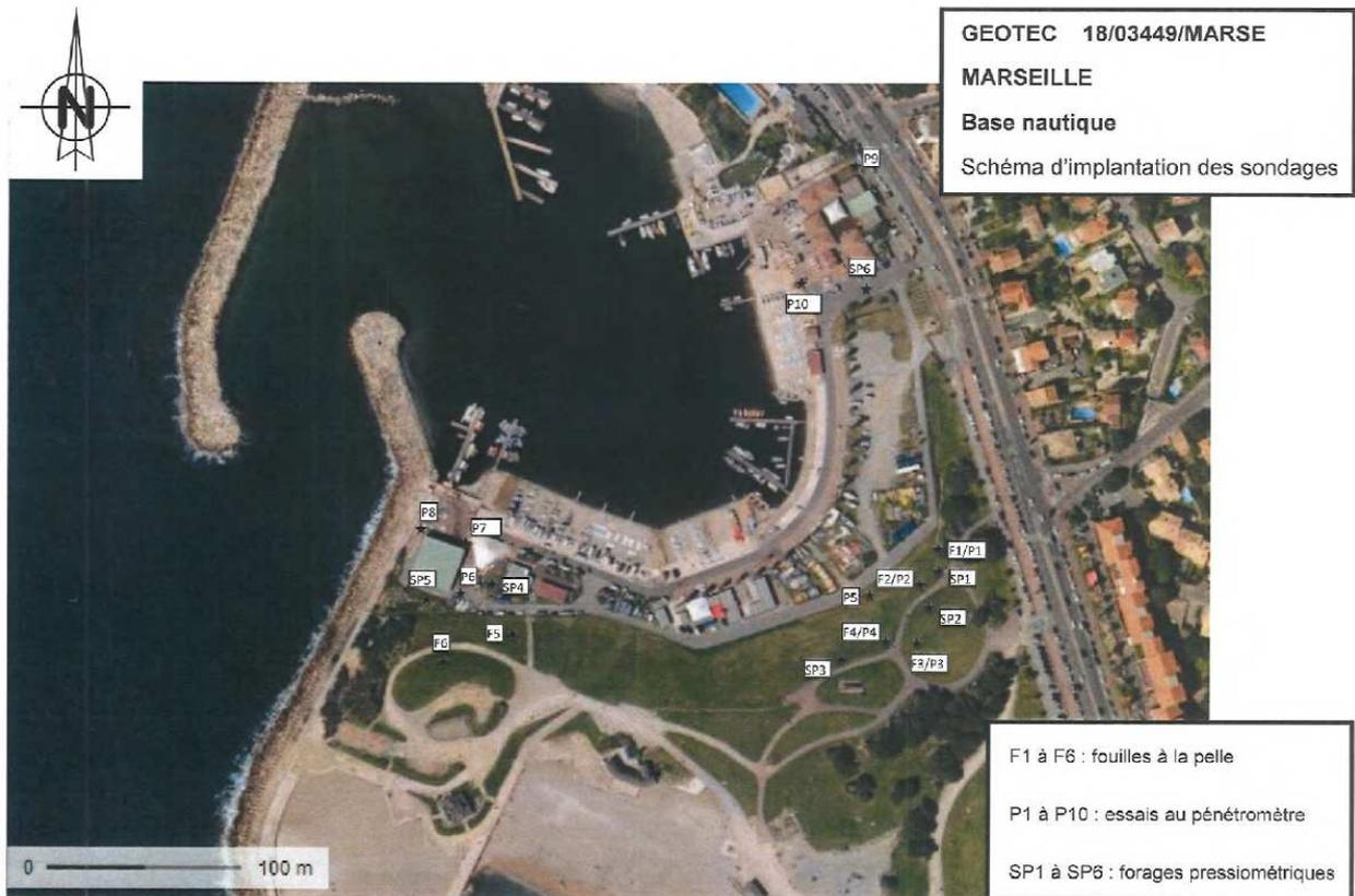
Figure 47 : Position des sondages (Source : Géotec 2018)
