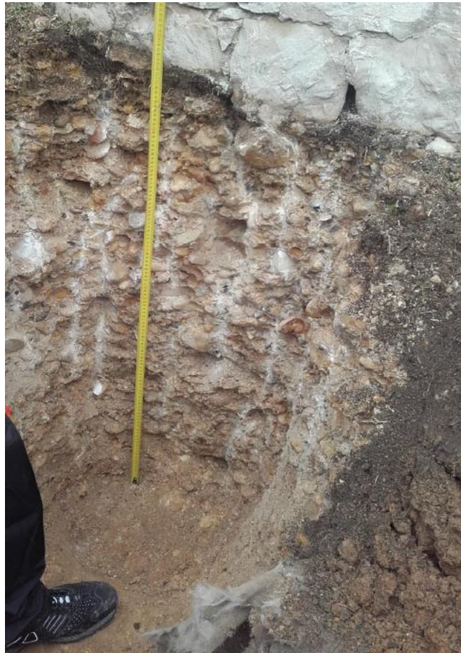
Vue d'une fouille terrassée au BRH au sein de poudingue du substratum Stampien (CAL BUSSERADE – situé à 70 m environ à l'Ouest du projet).
