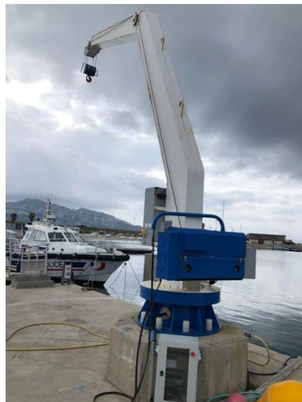
L'alimentation de la grue sera réalisée directement depuis une attente électrique amenée le marché des Travaux Terrestres. Le raccordement se fera au travers un coffret électrique accueillera les organes électriques nécessaires à la protection des équipements. Le
