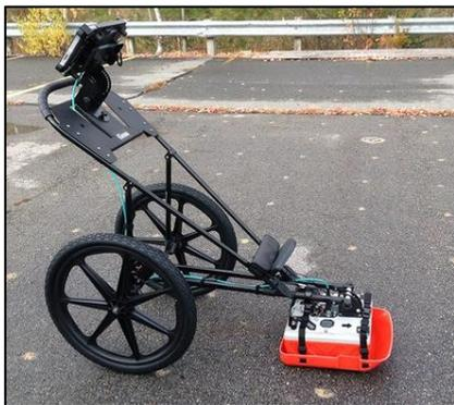
**Figure 6 : Géoradar Mala Locato HDR Monitor (N° Série 14247001 - "Bleu")**
