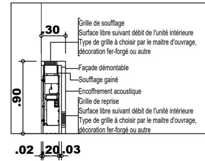
**Principe d'encoffrement ventilo vue de face**
