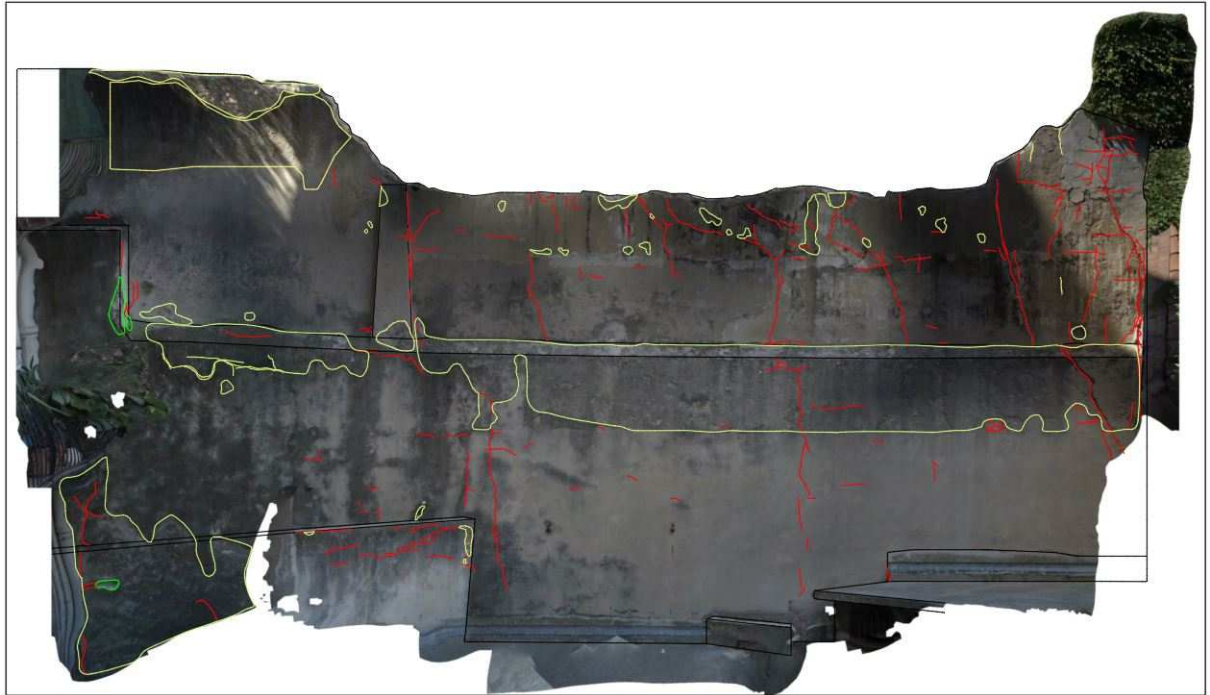
Mur Est de la butte : orthomosaique avec report de désordres
