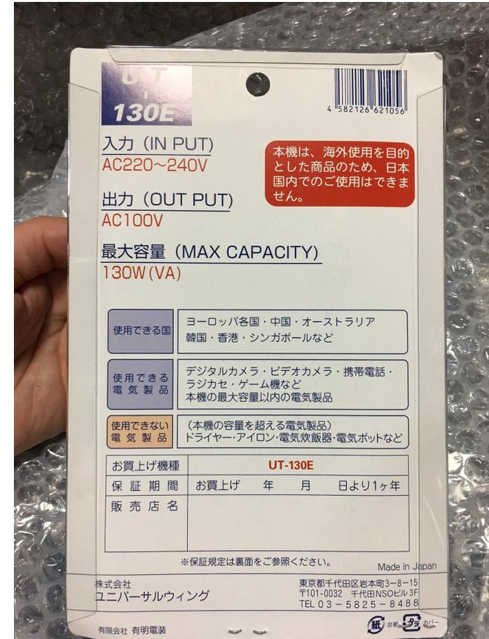
Caractéristiques techniques d'un transformateur compatible avec les normes européennes
