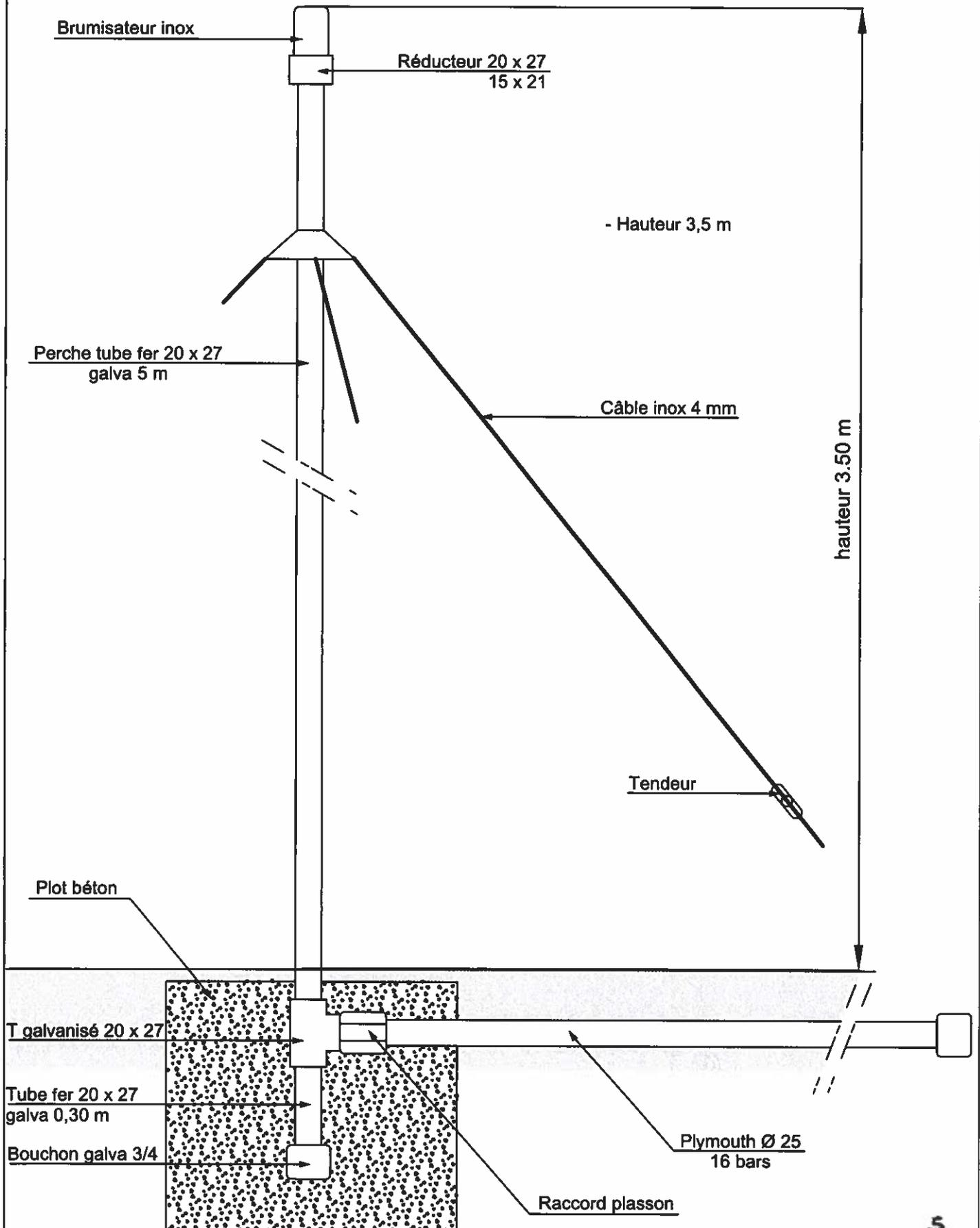
SCHEMA DE PRINCIPE DE POSE
