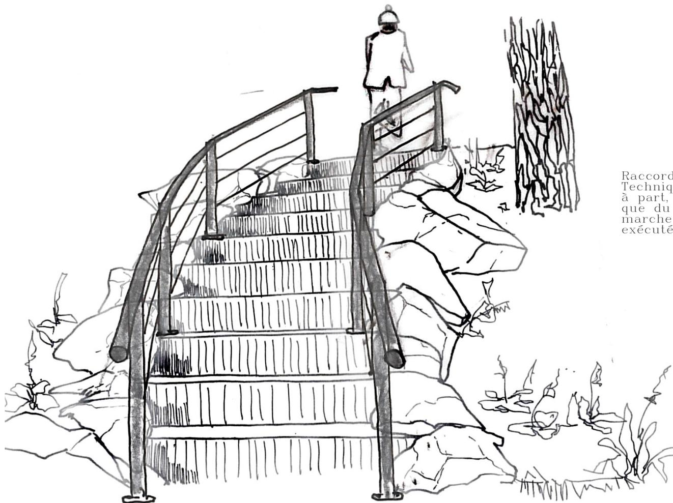
Raccordement des marches à l'enrochement. Techniquement, l'escalier est d'abord réalisé à part, les blocs sont ensuite disposés avant que du béton ne soit inséré entre la marche et le rocher. La finition est exécutée à la truelle, puis frottassée.
